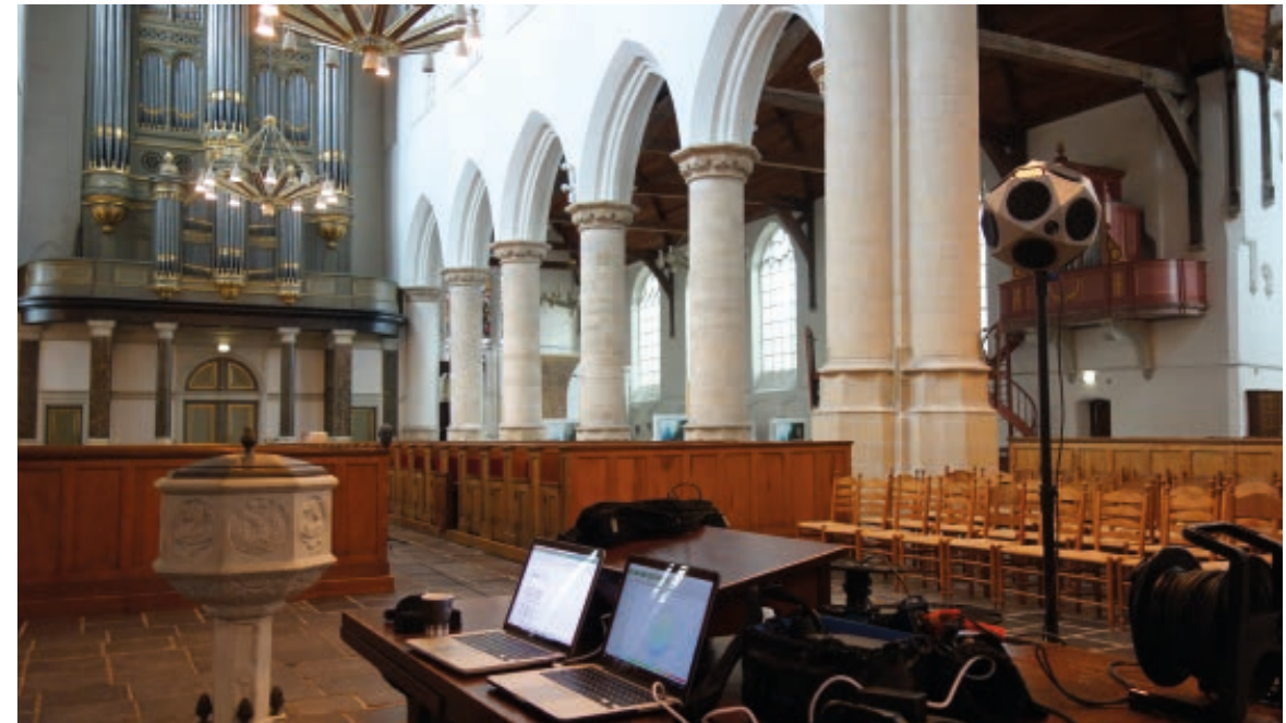
Met onder meer een luidspreker die naar alle kanten geluid uitzendt (de bol rechts op de foto) bracht akoestisch adviseur Jan Bril de akoestiek in kaart van honderd Nederlandse kerken, waaronder de Oude Kerk in Delft.
